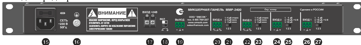
Рис. 2. Задняя панель МП. 15 – соединитель и предохранитель питания ~230В, 16 – клемма защитного заземления, 17 – клеммная колодка питания =24В, 18 – выключатель заземления, 19 – соединитель выхода, 21, 23, 25, 27 – микропереключатели уровня 4, 3, 2, 1 входа, 20, 22, 24, 26 – соединители 4, 3, 2, 1 входа.
