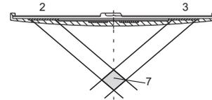
В случае возникновения пожара свет рассеивается частицами дыма и попадает на фотодиоды (2), которые преобразуют количество света в пропорциональный электрический сигнал.
