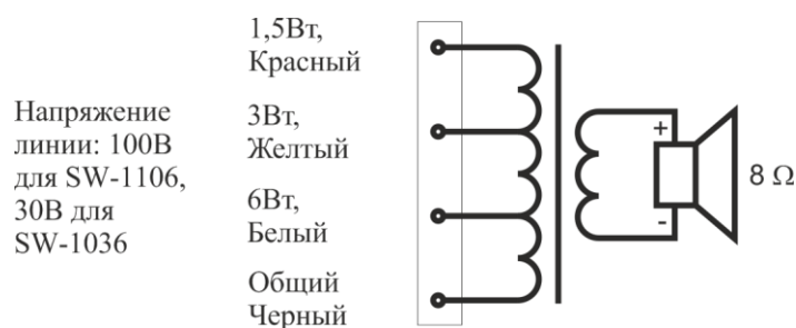
Рис. 2. Схема подключения оповещателя.
