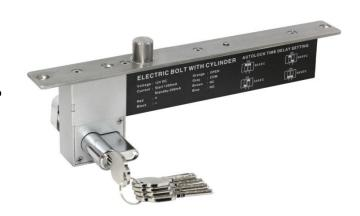
Электромеханический соленоидный замок ST-DB526MLT предназначен для работы в составе систем контроля доступа с электронным управлением блокировкой дверей. Замок ST-DB526MLT является нормально-закрытым, т.е. разблокируется при подаче питания и блокируется при отключении. Дополнительно устройство имеет возможность механической разблокировки с помощью ключа / поворотной ручки. Для мониторинга положения створки двери в системе контроля доступа можно использовать соответствующий выход замка.
