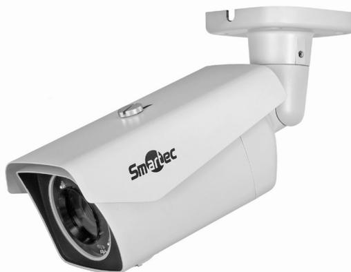
IP-камера STC-IPM3671 Хаго использует 1/2.8'' 2-мегапиксельную КМОП-матрицу Sony Exmor™ совместно с процессором обработки сигнала XARINA™, обеспечивающим особо высокий фреймрейт (до 50 к/с) и реализацию функции широкого динамического диапазона (120 дБ) на основе двойного сканирования. Высокий фреймрейт дает возможность детально рассмотреть видео от динамичных объектов, в то время как широкий динамический диапазон позволяет использовать камеру в условиях особо контрастного освещения.
