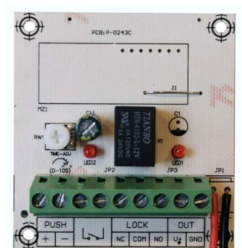
Модуль задержки ST-PS100TB предназначен для расширения базового функционала источников питания ST-PS103, ST-PS105, ST-PS103B-BK, ST-PS103C-BK, ST-PS105C-BK, ST-PS105D-BK, ST-PS110E-BK и ST-PS110F-BK. Устройство обеспечивает задержку включения линия питания.
