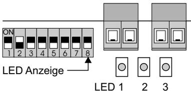
Mit dem **DIP-Schalter S8** wird der Anzeigebetrieb der LEDs definiert.
