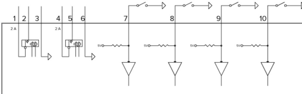
1. Выход 2 (вывод реле) — выходы сухих контактов формы А (нормально разомкнутые). Когда они замкнуты, клеммы подключены. Клеммы не подключены, когда контакты разомкнуты.
