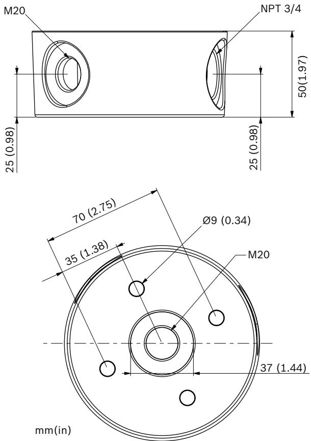
**Дополнительный подвесной кронштейн для установки на стену**
