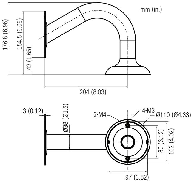
**Дополнительный подвесной кронштейн для установки на трубу**
