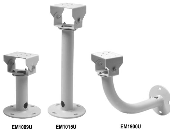
Узлы **EM1009U/EM1015U/EM1900U** представляют собой крепления кожухов, выдерживающие нагрузку до 40 фунт. (18,14 кг) и предназначенные для средних условий эксплуатации. Эти универсальные крепления, предназначенные для установки на потолке, опорной стойке и стене, могут использоваться с кожухами Pelco с крепежными отверстиями, находящимися на расстоянии 2" (5,08 см) друг от друга.
