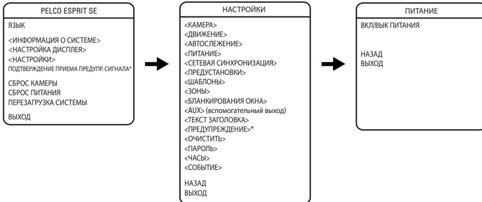
Эта функция позволяет задать операцию (сканирование, обработка предустановки или шаблона), выполняемую после того, как устройство будет выключено и затем включено.
