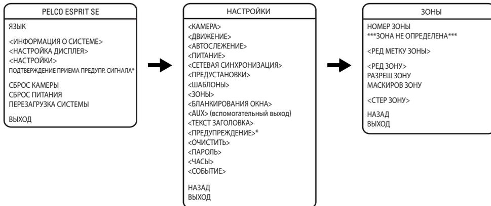
Зоной называется участок панорамирования, определяемый левым и правым пределами в плоскости панорамирования, занимающей 360°. Устройство рассчитано на восемь зон с метками по 20 знаков для каждой.
