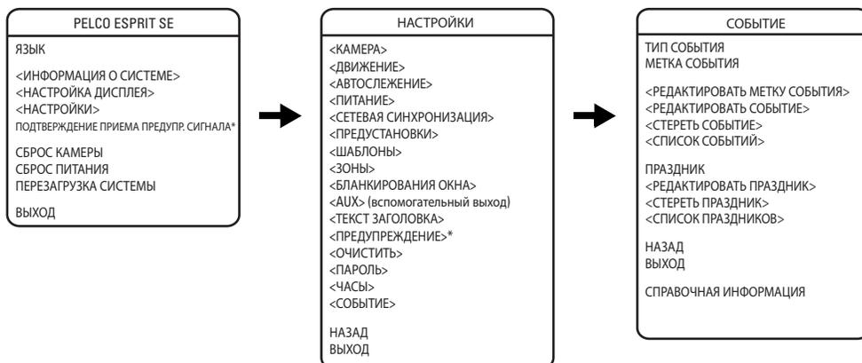
Событием называется заранее настроенная функция камеры, парковка, сканирование, предустановка, шаблон, бланкирование (маскирование) окна, тревожная сигнализация или вспомогательная функция, которая может выполняться автоматически в заданный день и время.
