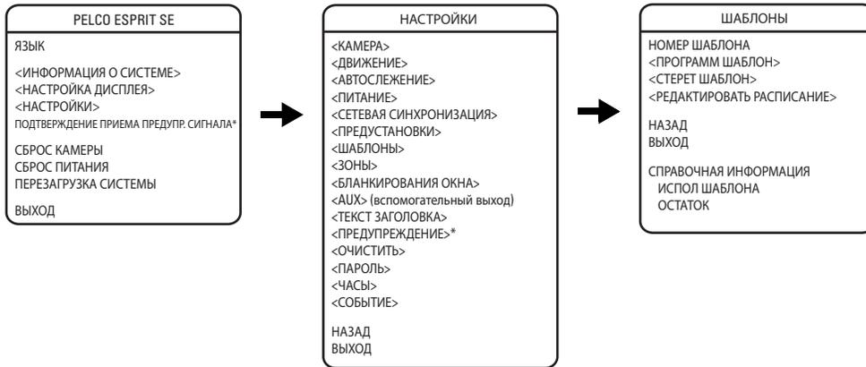
Шаблон (или циклограммой) называется записанная в память повторяющаяся последовательность операций панорамирования, наклона, трансфокации и отработки предустановок, которая может быть вызвана по команде с контроллера или автоматически по настроенной функции (при срабатывании сигнализации, парковке, наступлении заданного события или при включении системы).
