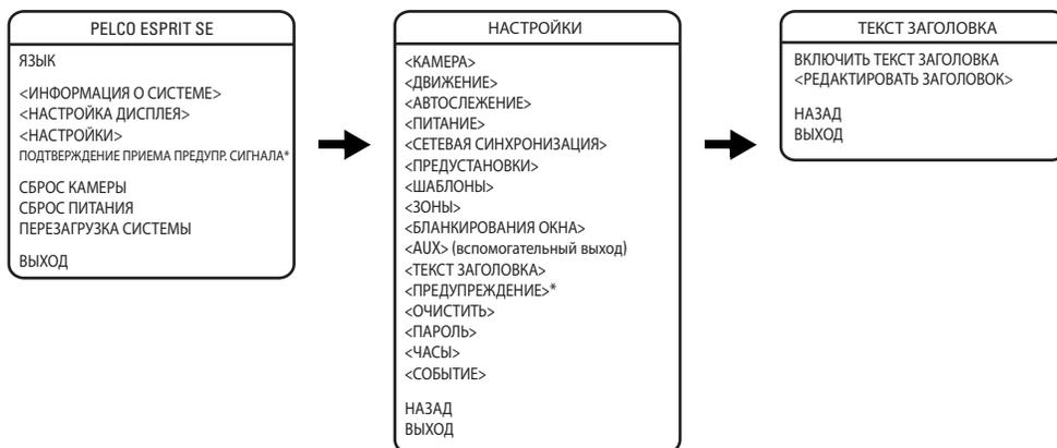
Текст заголовка представляет собой метку, используемую для идентификации камеры, изображение с которой просматривается на мониторе. Длина заголовка может составлять до 20 знаков.
