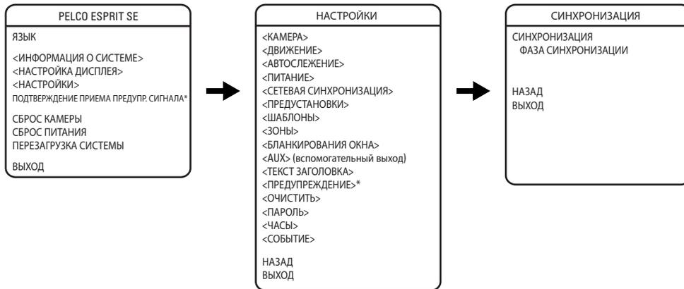
Сетевая синхронизация представляет собой настраиваемую функцию, которая дает возможность синхронизировать все камеры в матричной системе.
