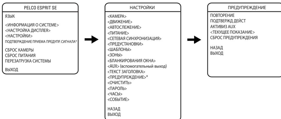
**ПРИМЕЧАНИЕ:** опция Alert (Предупреждение) применяется только для герметизированных устройств. В негерметичных устройствах эта позиция меню не показывается.
