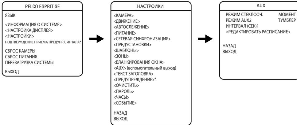
Вспомогательный выход выдает настраиваемый сигнал системы Esprit SE, который может использоваться для включения другого устройства. Можно задать включение вспомогательного выхода по срабатыванию сигнализации или по команде с контроллера.
