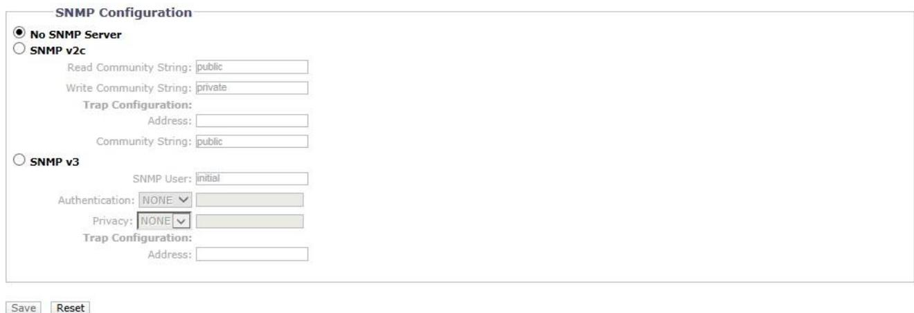
**FIGURE 3-17: SNMP CONFIGURATION**
