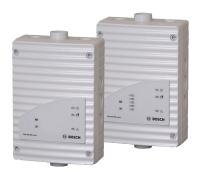
Аспирационные дымовые извещатели серии FCS-320-ТМ представляют собой активные системы обнаружения возгорания, предназначенные для раннего обнаружения возгорания в помещениях, оборудовании, устройствах кондиционирования воздуха или вентиляционных каналах. Точное место возгорания можно определить благодаря инновационной технологии локализации источника пожара.
