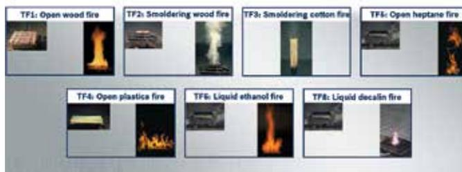
Система **AVIOTEC** срабатывает при испытательных пожарах уровней TF1 – TF8: открытое целлюлозное (древесное) пламя (TF1), тлеющий древесный огонь (TF2), тлеющий огонь при горении хлопка (TF3), открытое пламя при горении пластика (TF4), открытое пламя n-гептана (TF5), горение метилированного спирта (TF6), низкотемпературный черный дым (декалин) (TF8).
